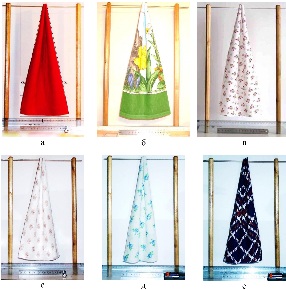
Рис. 1. Определение драпируемости методом «иголки» различных материалов
